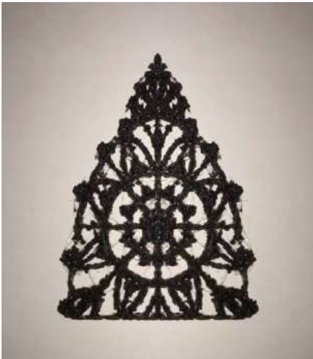
Рисунок 3.23. Кружевоподобные элементы, созданные при помощи 3D-печати: а – прототипированный элемент женского воротника; б – прототипированный элемент отложного мужского воротника
